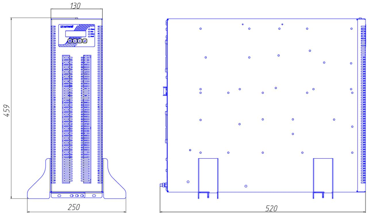
Рисунок 2а – Габаритные размеры стабилизаторов
