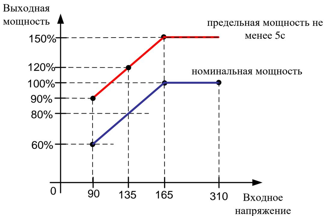
Рисунок 11 – Зависимость выходной мощности от входного напряжения
