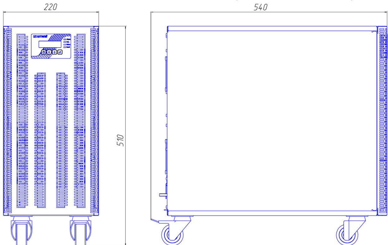
Рисунок 2б – Габаритные размеры стабилизаторов
