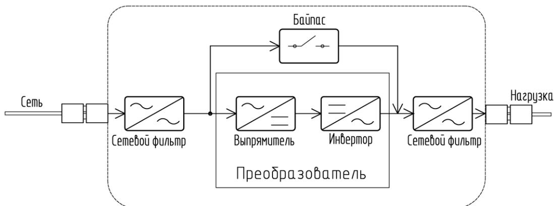
Рисунок 4 – Структурная схема принципа работы стабилизатора
