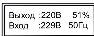
Рисунок 6 – ЖК-дисплей в режиме основного экрана
